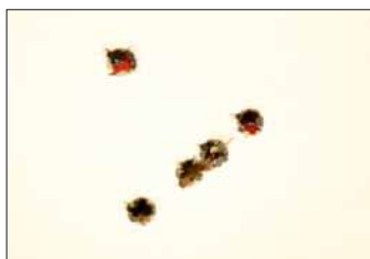
Rosata di 5 cartucce Focchi Fmj 123 gr in tiro di precisione a 15 m. Diametro rosata tra i centri, 52 mm.
